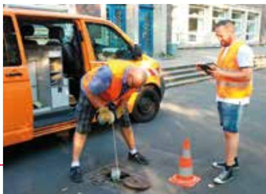
Messung des Grundwasserstandes mit Hilfe eines Lichtlotes
